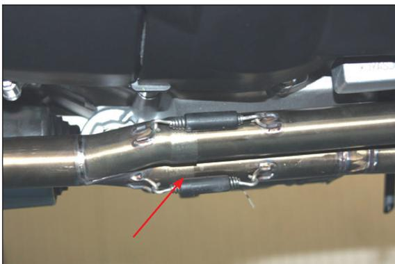
Montare il raccordo sui collettori e fissarlo con le molle fornite nel kit
